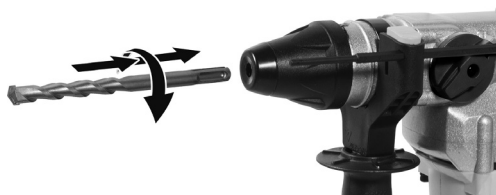
Fig. 2 – Dibujo demostrativo para instalación del accesorio
